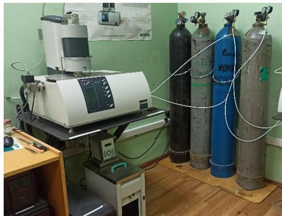
Рисунок 2.4 – Термоанализатор STA 449 F1 Jupiter NETZSCH
