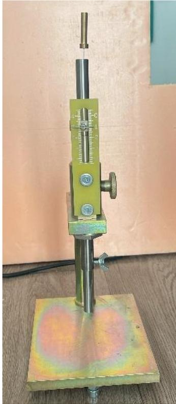
Рисунок 2.14 – Прибор Вика ОГЦ-1
