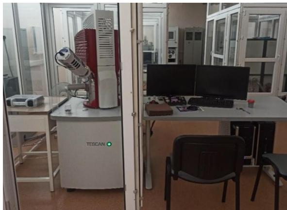
Рисунок 2.3 – Сканирующий электронный микроскоп Mira 3 FesSem
