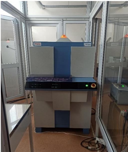
Рисунок 2.1 – Рентгеновская рабочая станция WorkStation ARL 9900
