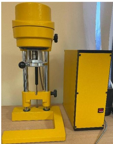
Рисунок 2.10 – Ротационный вискозиметр Rheotest RN4.1
