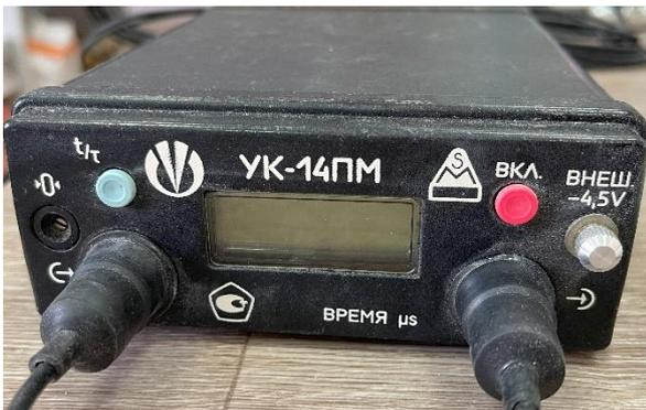
Рисунок 2.8 – Бетоноскоп УК-14ПМ
