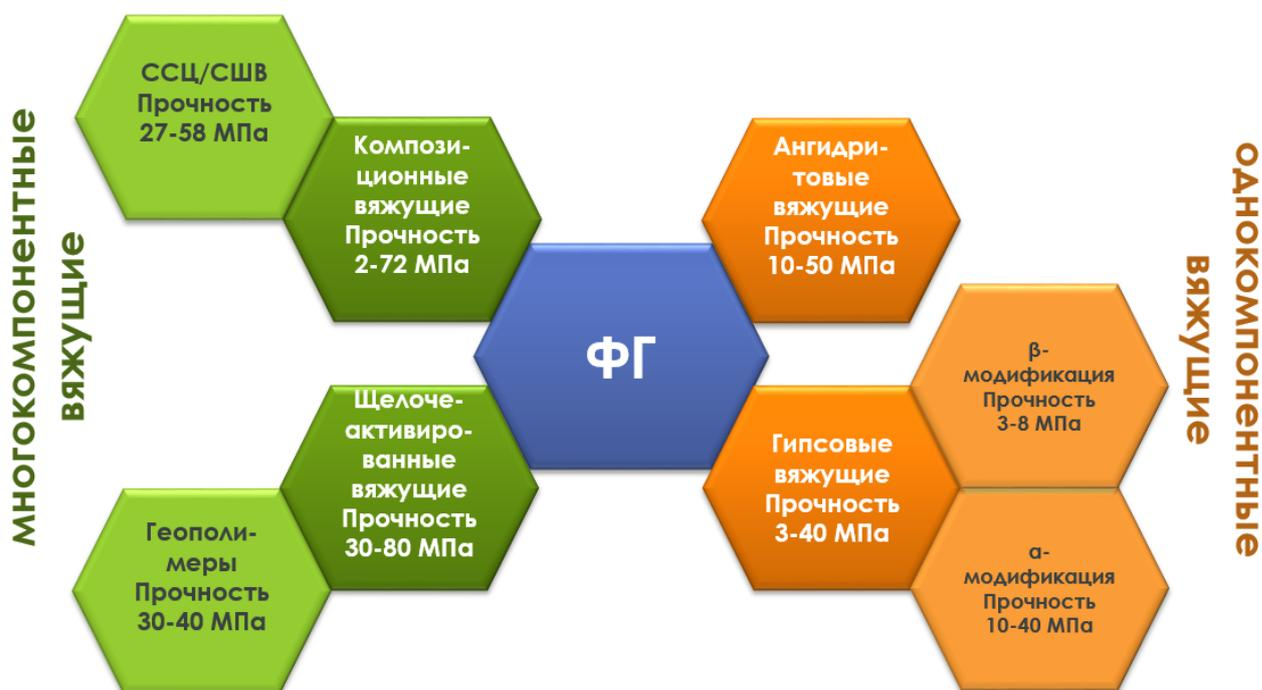
Рисунок 1.1 – Одно- и многокомпонентные вяжущие с использованием фосфогипса
