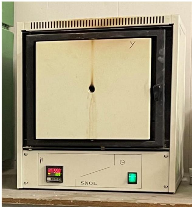
Рисунок 2.19 – Лабораторная муфельная печь для изготовления ФАВ
