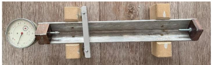
Рисунок 2.9 – Устройство для определения деформационной усадки
